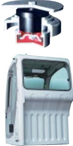
Ruhige Kabine mit niedrigem Geräuschpegel dank einer an der Rückseite angebrachten Isolationsplatte mit tiefen Aussparungen. Auch die Vibration wird minimiert, und zwar mit Hilfe von abgedichteten Viskose-Kabinendämpfern.
